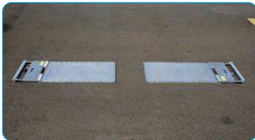
Figs. 3a e 3b - Alinhamento das balanças
