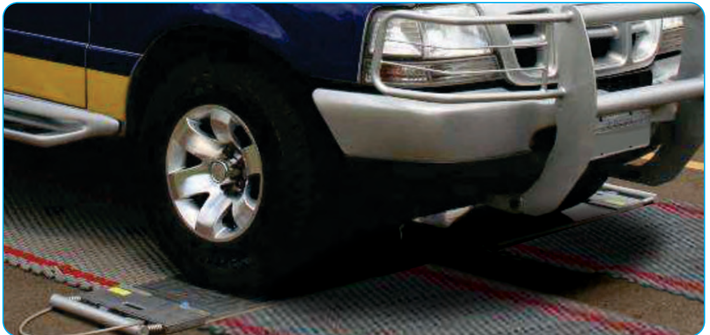
Fig. 18 - Posição correta de pesagem por eixo. As rodas se encontram entre as linhas de referência das balanças tanto longitudinalmente quanto lateralmente.
