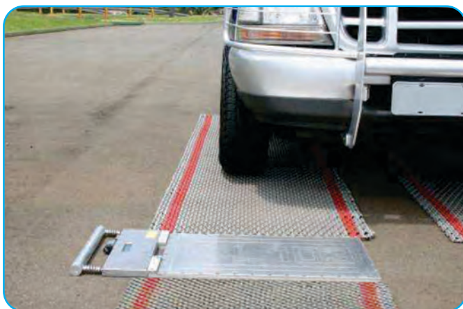
Fig. 16 - Posicionamento correto da roda na esteira e balança (entre as faixas vermelhas)
