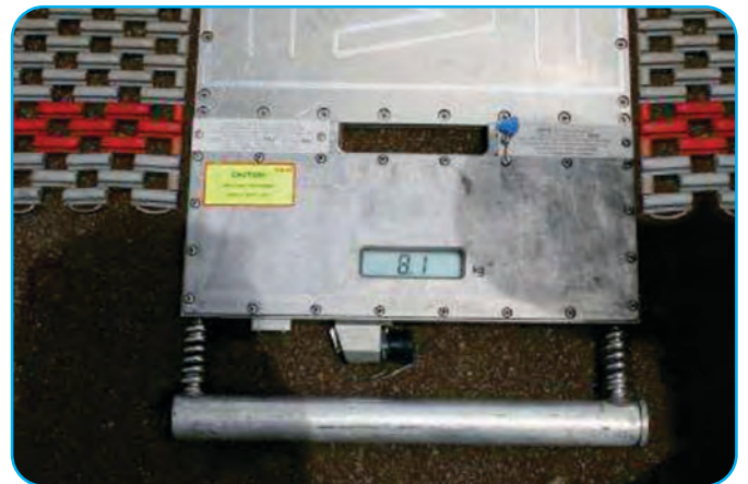
Fig. 11 - Voltagem (relativa à carga das baterias da balança)
