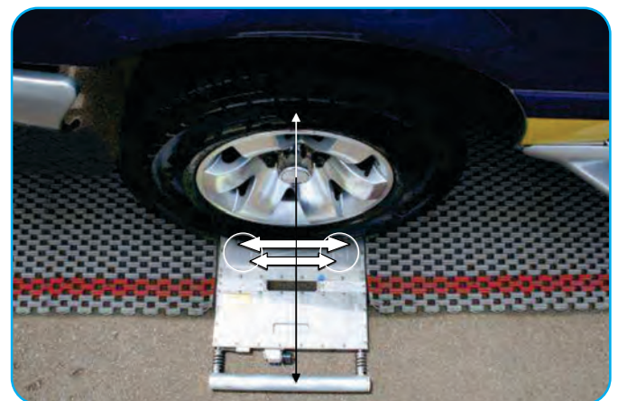
Fig. 17 - Posicionamento correto do conjunto pneu-roda na balança
