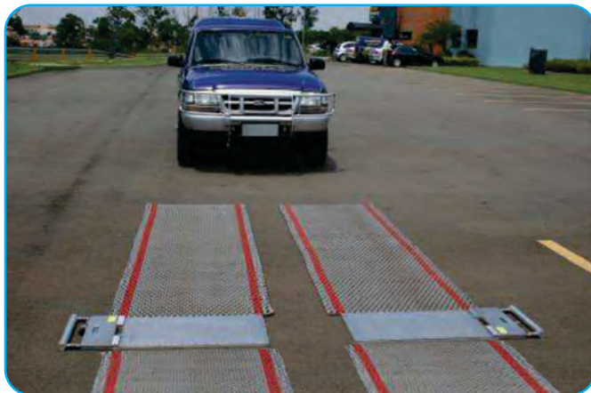
Fig. 14 - Alinhar o veículo com as linhas vermelhas indicativas na esteira
